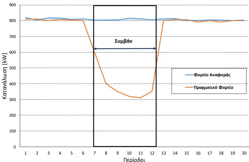
Σχήμα 1 Φορτίο Αναφοράς Χαρτοφυλακίου Κατανεμόμενου Φορτίου
